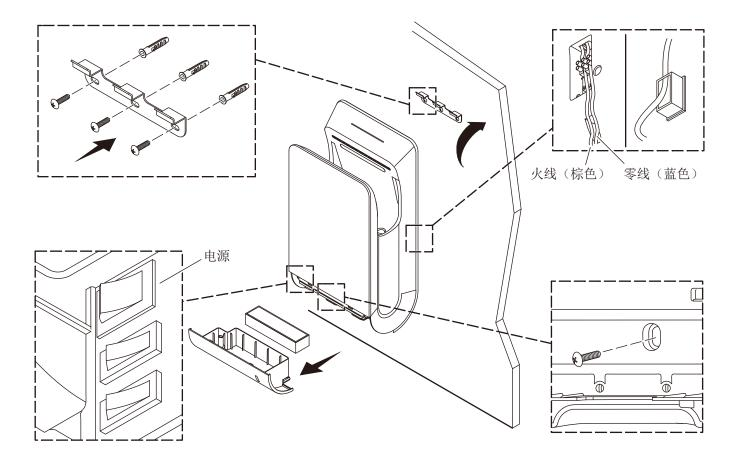
重要信息! 确认干手机正确安装后, 拧入防盗螺丝以防止机器掉落或被盗。
