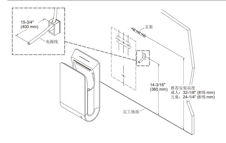
**重要信息!** 请连接到固定线路的额定交流电源。并使用 AWG16(1.5  $\mathrm{mm}^2$  - 2  $\mathrm{mm}^2$ ) 电源线。请保留电源线长度为 15-3/4" (400  $\mathrm{mm}$ ) 以供连接。
